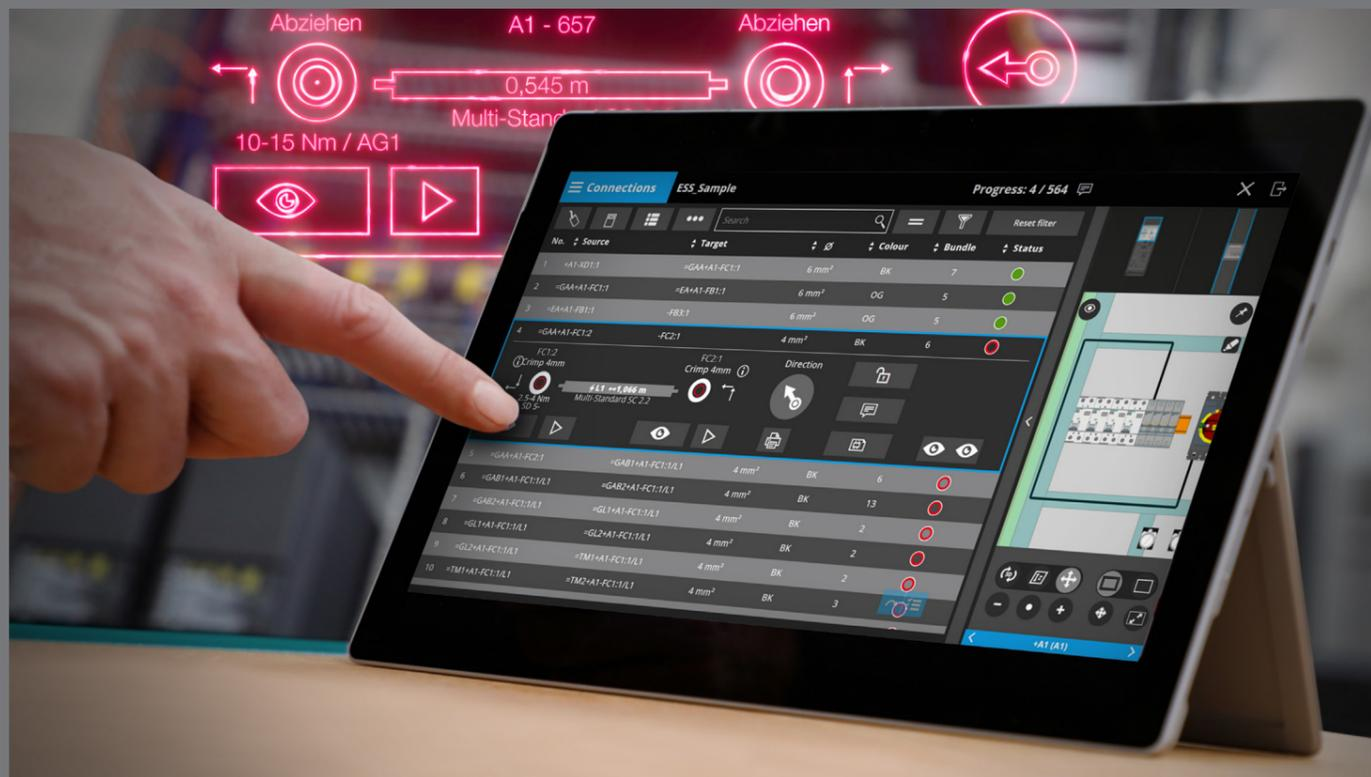
Auf derselben Datenbasis, dem digitalen Zwilling aus Eplan Pro Panel, und mit derselben Bedienoberfläche fungiert Eplan Smart Wiring als Verdrahtungs-Navi, das den Verdrahtungsprozess übersichtlich und Schritt für Schritt visualisiert.
